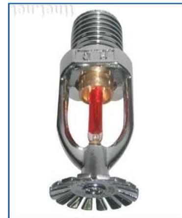
当温度达到68度时玻璃管爆裂，将自动喷水灭火；
